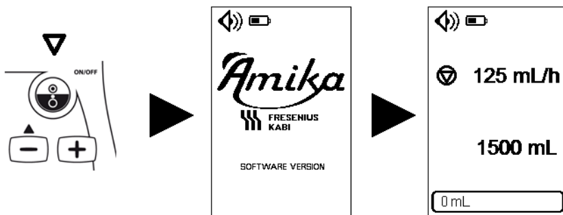
Abbildung 4: Selbsttest der Ernährungspumpe
